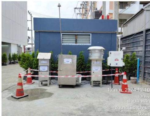
รูปที่ 6 ติดตั้งเครื่องตรวจวัดคุณภาพสิ่งแวดล้อม
